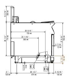
Electrical inlet (power) EQ Equipotential screw
